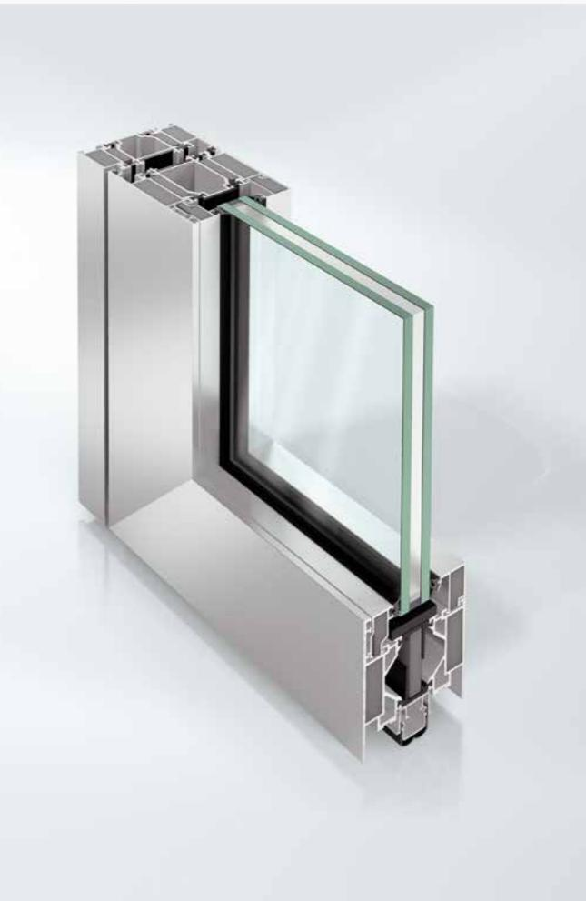
Das bewährte Türsystem ADS 80 FR 60 (Fire Resistant) mit der Bautiefe 80 mm basiert auf hochstandfesten 5-Kammer-Hohlprofilen. Es ist geeignet für Tür- und Wandelemente für Brandschutz der Feuerwiderstandsklasse EI60 (T60, F60).
