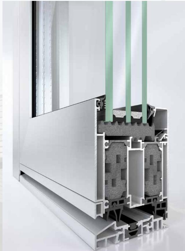
Konzipiert für anspruchsvollste Projektlösungen im Wohn- und Objektbau: Das hochstabile Türsystem AD UP 90 mit einer Bautiefe von 90 mm basiert auf einem 3-schaligen Konstruktionsprinzip mit doppeltem Mitteldichtungssystem, das höchste Energieeffizienz, Dämm- und Dichtheits-eigenschaften sichert.
