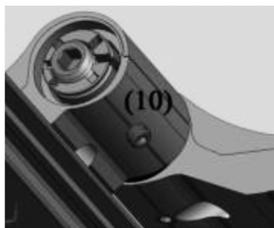
Bei geöffneter Tür Innensechskantschraube M6x5 (10) im Ober- und Unterteil lösen.
