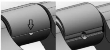
Benutzen Sie die technische Öffnung, um die Abdeckung mit einem flachen Schraubendreher anzuheben und so an die Regulieröffnung zu gelangen. Die Regulierung erfolgt durch Drehen der Regulierschraube mit Inbusschlüssel #4.
